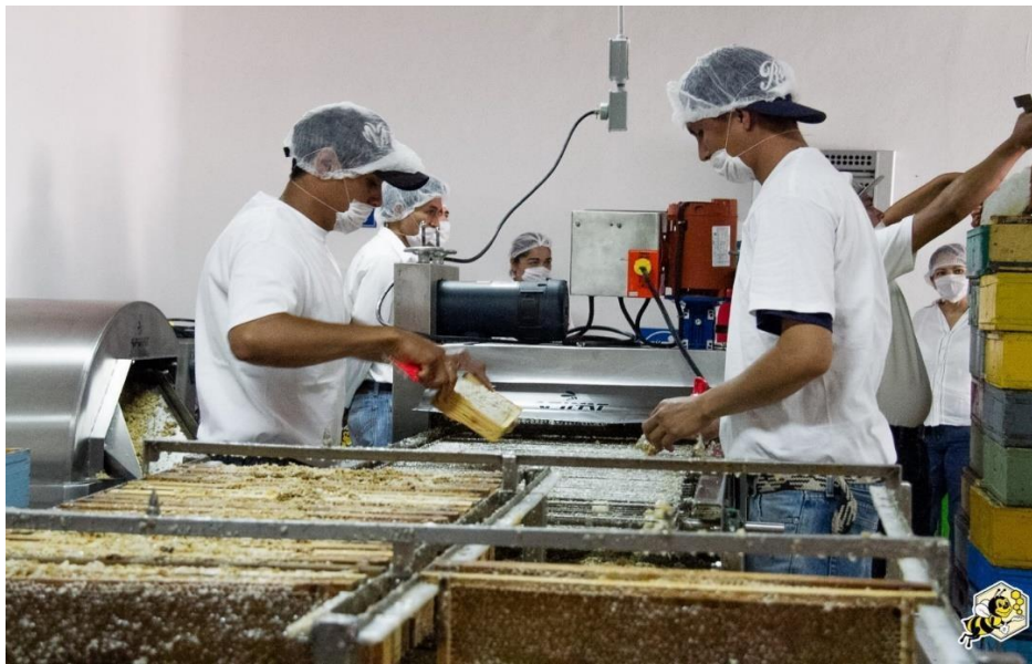
Figura 12. Proceso de perforado de bastidores para tener una mejor centrifugación 21
