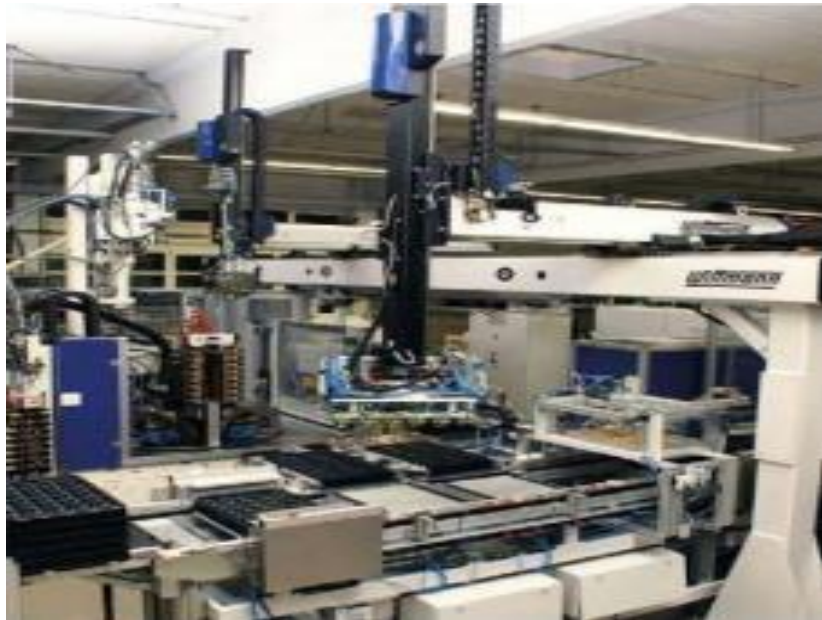
Figura 11. Robot Cartesiano, Aplicación industrial para el corte de plástico 18
