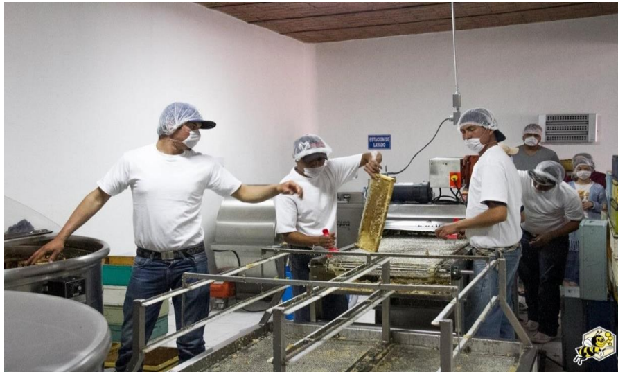
Figura 13. Proceso manual del traslado de los bastidores para el llenado de la centrifugadora 22
