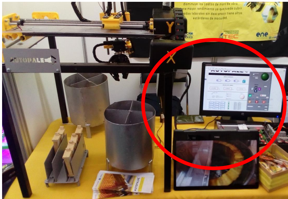
Figura 67. Se muestra el robot cartesiano completo donde se puede apreciar que es fácil desconectar el cable de conexión (robot-caja).
