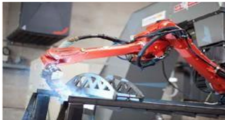
Figura 3. Se muestra un brazo robótico industrial en el área de soldadura para un proceso en serie 7
