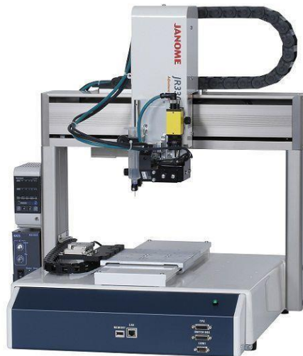
Figura 8. Robot Cartesiano, con aplicación a la industria eléctrica 14
